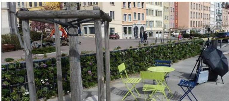
Les écrans anti bruit de petites tailles constituent une technique de protection contre les nuisances sonores qui permet des gains acoustiques de 6 à 8 dB dB(A) selon la configuration du site.
